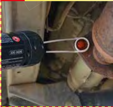
500.8605 Pistola termica ad induzione con accessori
